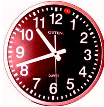
Wanduhr wird durch Aufspürgerät betrachtet, deutliche Reflektion zwischen 12 und 1 Uhr erkennbar.
