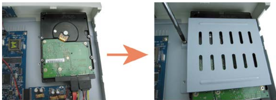
Schritt 4: Legen Sie die HDD hinein und bringen Sie die Halterung wieder an
