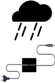
Netzteile: Ungeschützte Netzteile und Geräte mit einem Schutzgrad kleiner IP54 sind nur für Verwendung in trockenen Räumen geeignet. Ist eine Installation in feuchter Umgebung vorgesehen, so sind die Netzteile oder Geräte durch ein Gehäuse ab Schutzgrad IP54 zu schützen. Davon ausgenommen sind unsere Netzteile und Geräte, welche schon in Gehäusen ab Schutzgrad IP54 geliefert werden bzw. über diesen Schutzgrad verfügen.
