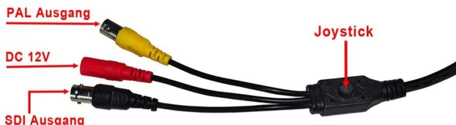
**Achtung:** Auf dem Joystick steckt bei einigen Kamerateypen eine Schutzkappe die vor dem Einstellen abgezogen werden muss.
