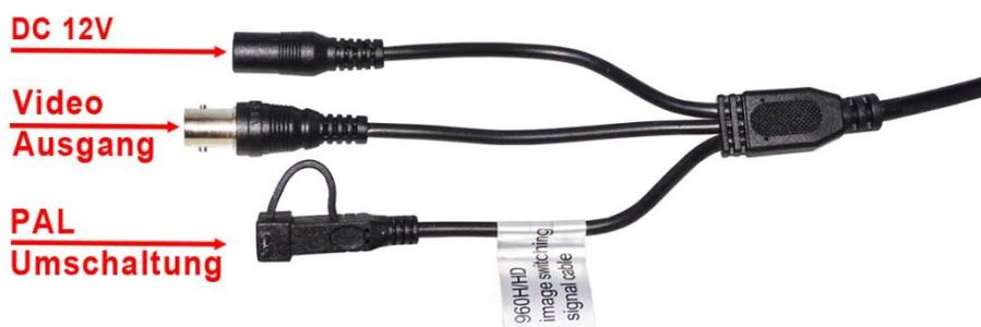
Der Jumper befindet sich im Deckel des Anschlusskabels. Dieser muss zum Umschalten auf PAL aus dem Deckel genommen und auf die Kontakte des Anschlusskabels gesteckt werden. Danach kann der Deckel wieder als Schutz aufgesetzt werden. Siehe Bilder unten.
