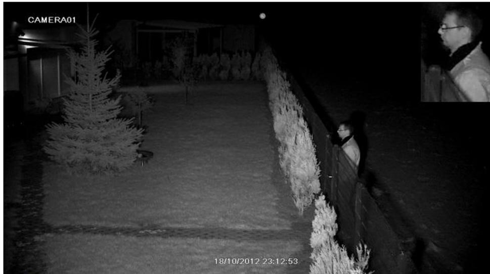
Das Bild zeigt zum Vergleich eine korrekte AGC-Einstellung bezüglich Personenerkennung. Abgeschaltetes Sens-Up bzw. Low-Speed-Shutter realisiert die Erkennung bei Bewegungen.
