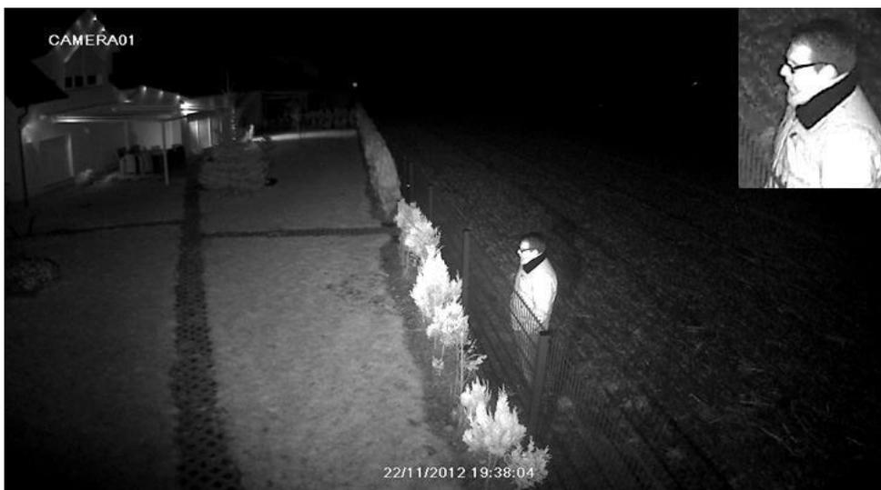
Bei Kameras mit festem Blickwinkel entspricht der Winkel der Infrarotausleuchtung weitestgehend dem Blickwinkel der Kamera (Objektiv), sodass die Ergebnisse bzgl. der Ausleuchtung ebenfalls und in in den meisten Fällen diesem Bild entsprechen.
