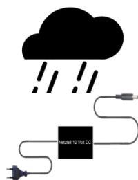
Netzteile: Ungeschützte Netzteile und Geräte mit einem Schutzgrad kleiner IP54 sind nur für Verwendung in trockenen Räumen geeignet. Ist eine Installation in feuchter Umgebung vorgesehen, so sind die Netzteile oder Geräte durch ein Gehäuse ab Schutzgrad IP54 zu schützen. Davon ausgenommen sind unsere Netzteile und Geräte, welche schon in Gehäusen ab Schutzgrad IP54 geliefert werden bzw. über diesen Schutzgrad verfügen.
