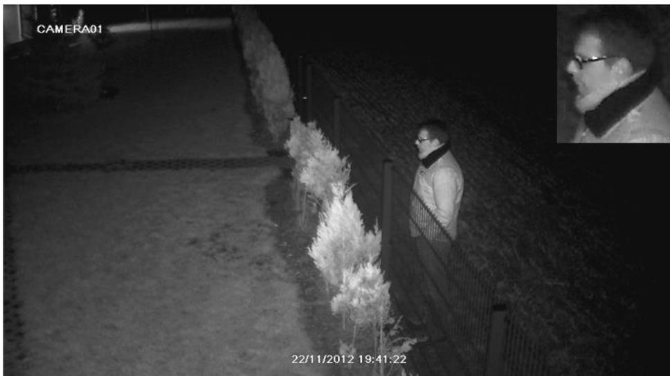
Die SDI-Kameras verfügen über einen festen Winkel der Infrarotausleuchtung (IR-LEDs) sowie über einen meistens variabel einstellbaren Kamerablickwinkel (Vario-Objektiv). Beide Größen sind in den technischen Daten der jeweiligen Kamera beschrieben. Im Bild oben beträgt der Leuchtwinkel der Infrarotkamera ca. 50 Grad, der Blickwinkel kann zwischen 100 und 45 Grad eingestellt werden und ist auf ebenfalls ca. 50 Grad eingestellt. Im Ergebnis ist der Bildbereich vollständig ausgeleuchtet.
