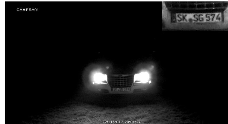
Das Bild mit KfZ-Nummernerkennung wird erreicht z. B. mit den Panasonic-Chip-Kameras. Das Auto steht, dass Fernlicht ist eingeschaltet.
