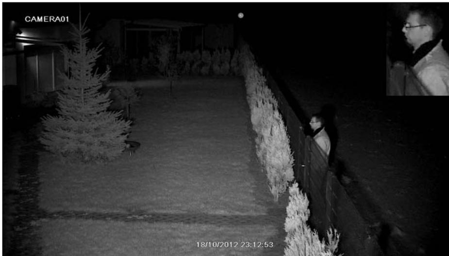
Das Bild zeigt zum Vergleich eine korrekte AGC-Einstellung bezüglich Personenerkennung. Abgeschaltetes Sens-Up bzw. Low-Speed-Shutter realisiert die Erkennung bei Bewegungen.
