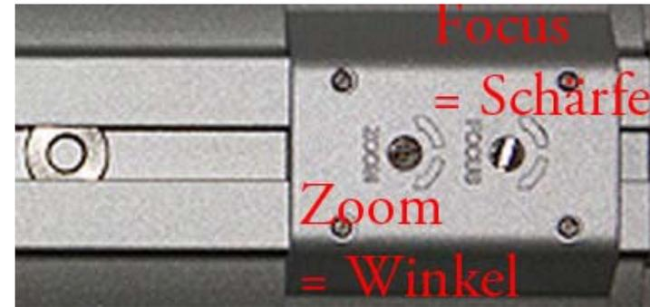
Kameras mit zugänglichem Objektiv, Dome-Kameras müssen vorsichtig geöffnet (aufgeschraubt bzw. Kuppel abgeschraubt) werden. Vorsichtig betätigen, möglichst Positionen am Anschlag vermeiden.
