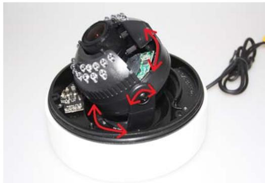
Diese Kamera auf 3-Achsen positioniert werden, somit ist ein vollständiger Ausgleich der Bildachse möglich. Die Kamera kann somit auch an Wänden und Schrägen montiert werden.
