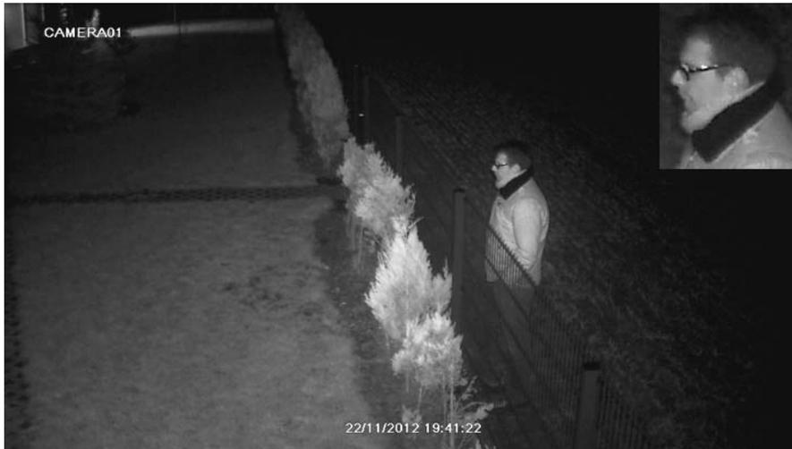
Die SDI-Kameras verfügen über einen festen Winkel der Infrarotausleuchtung (IR-LEDs) sowie über einen meistens variabel einstellbaren Kamerablickwinkel (Vario-Objektiv). Beide Größen sind in den technischen Daten der jeweiligen Kamera beschrieben. Im Bild oben beträgt der Leuchtwinkel der Infrarotkamera ca. 50 Grad, der Blickwinkel kann zwischen 100 und 45 Grad eingestellt werden und ist auf ebenfalls ca. 50 Grad eingestellt. Im Ergebnis ist der Bildbereich vollständig ausgeleuchtet.
