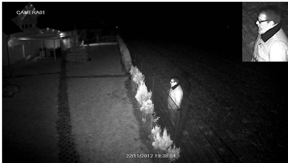
Bei Kameras mit festem Blickwinkel entspricht der Winkel der Infrarotausleuchtung weitestgehend dem Blickwinkel der Kamera (Objektiv), sodass die Ergebnisse bzgl. der Ausleuchtung ebenfalls und in den meisten Fällen diesem Bild entsprechen.
